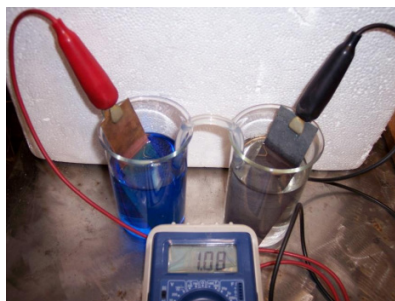
Зураг 2. Цайр- зэсийн гальваны хэлхээг угсарсан байдал
